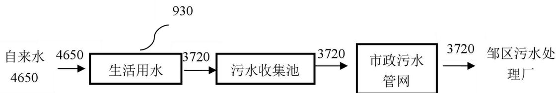
图 1-1 建设项目用排水平衡图 (单位 t/a)
