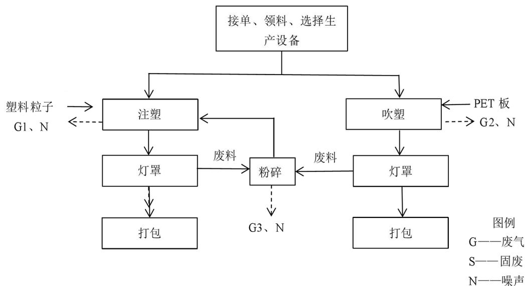
图 2-1 灯具灯罩生产工艺流程图
