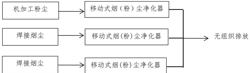
图 2-4 废气处理流程图
